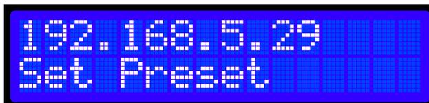
2. **Configuração de patrulha:** A patrulha é uma junção de presets. Para configurar, pressione **"Set Pattern"** e irá aparecer uma tela no display conforme imagem abaixo, em seguida, pressione **"Call Preset"** e o número referente ao preset e aperte **"Enter"**. Faça isso até adicionar todos os presets que deseja na patrulha.
